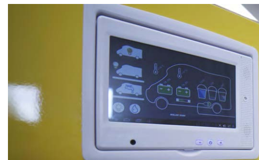
04 Camper TRIACA Particolare dell'interfaccia relativa al monitoraggio e alla gestione dei consumi del veicolo
