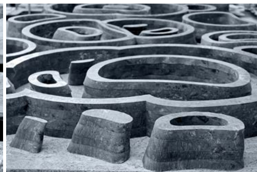
04 Taglio a water-jet a 5 assi per Agave. R. Galiotto, 2016
