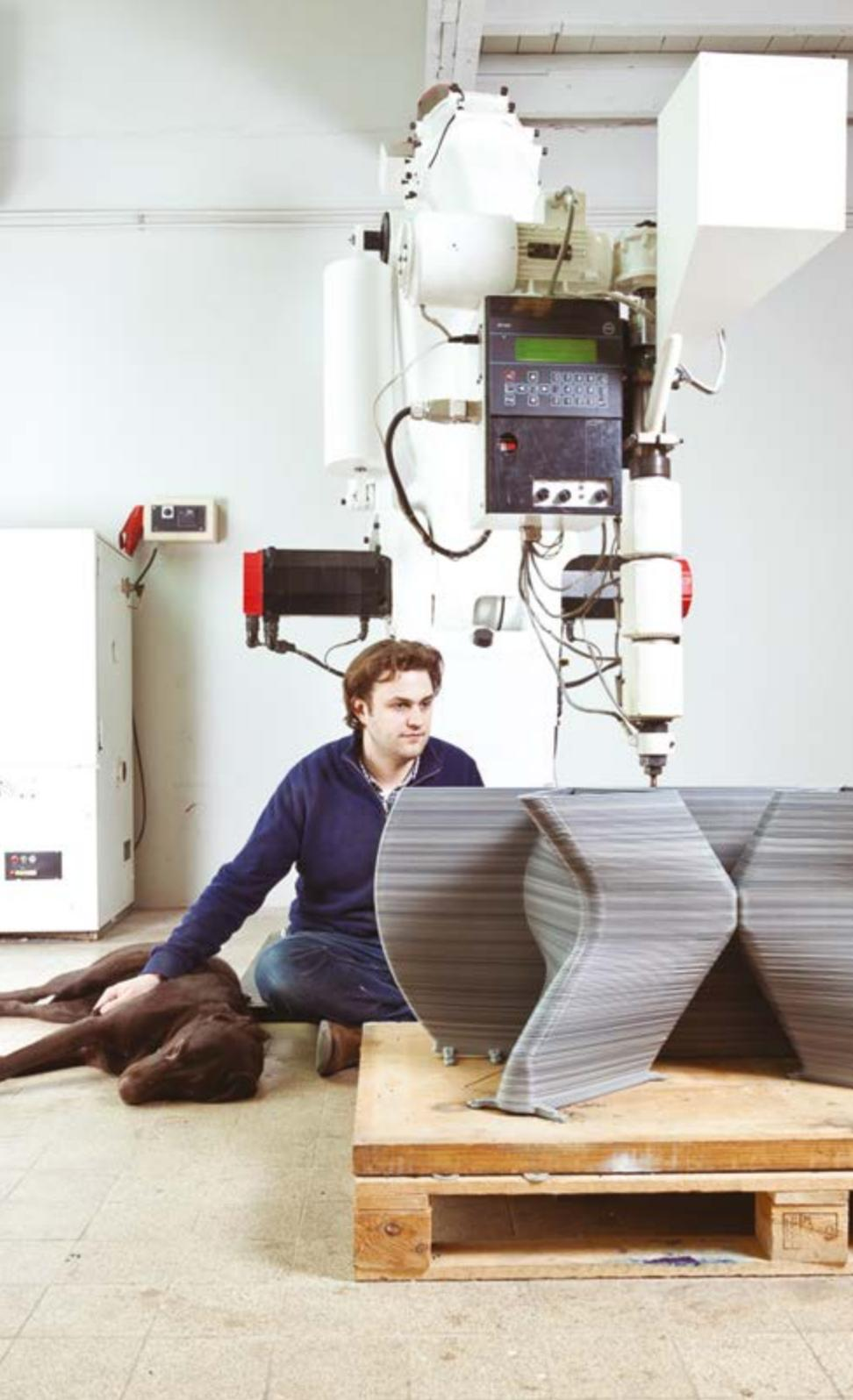
Lo sviluppo di ulteriori processi innovativi, in chiave di rapporto tra materiale, macchina e *additive manufacturing*, sta avvenendo con la combinazione tra robotica e materiale, come nell'impiego del braccio antropomorfo per l'istruzione di polimeri termoplastici (anche riciclati), utilizzato dall'olandese Dirk Vander Kooij per i suoi oggetti autoprodotti [fig. 05] e nelle sperimentazioni a saldatura continua del connazionale Joris Laarman.
