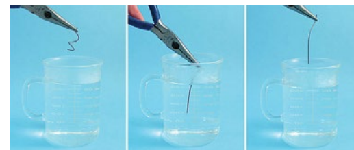
05 Il filo in Nitinol è deformato meccanicamente (sx): dopo il riscaldamento, recupera la configurazione originaria (dx). www. teachersource. com
