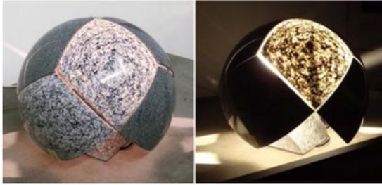
Il prototipo Sfera. Si noti la traslucenza del granito. (Giuseppe Fallacara con Generelli SA, 2015)
