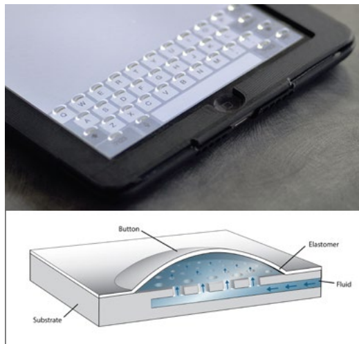
05 Esempio di interfaccia modificabile della Tactus Technology
